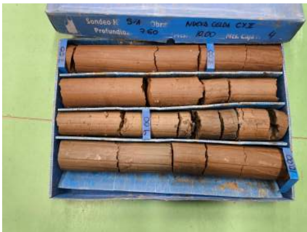
Sondeo S-1, caja 4, de 7,60 m a 10,00 m de profundidad.
