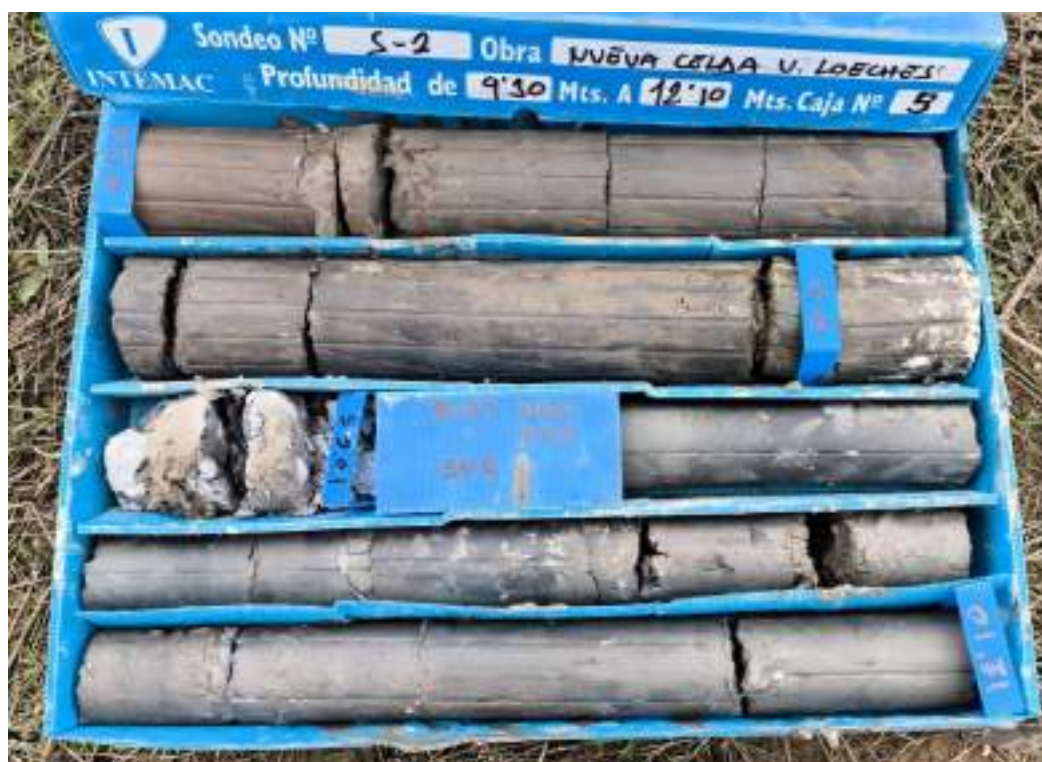
Sondeo S-2, caja 5, de 9,30 m a 12,10 m de profundidad.
