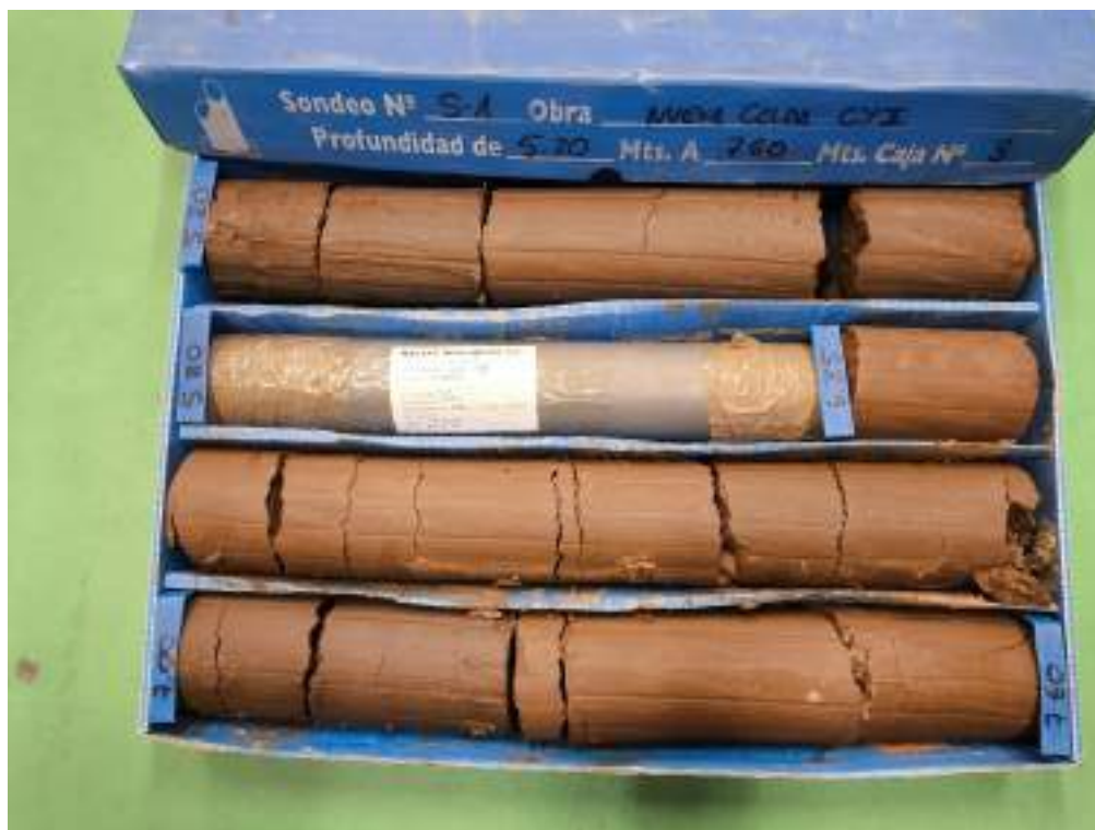
Sondeo S-1, caja 3, de 5,20 m a 7,60 m de profundidad.
