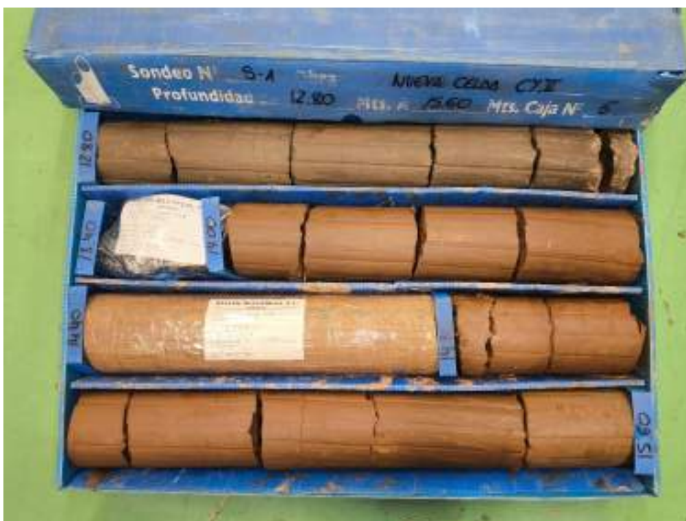
Sondeo S-1, caja 6, de 12,80 m a 15,60 m de profundidad.
