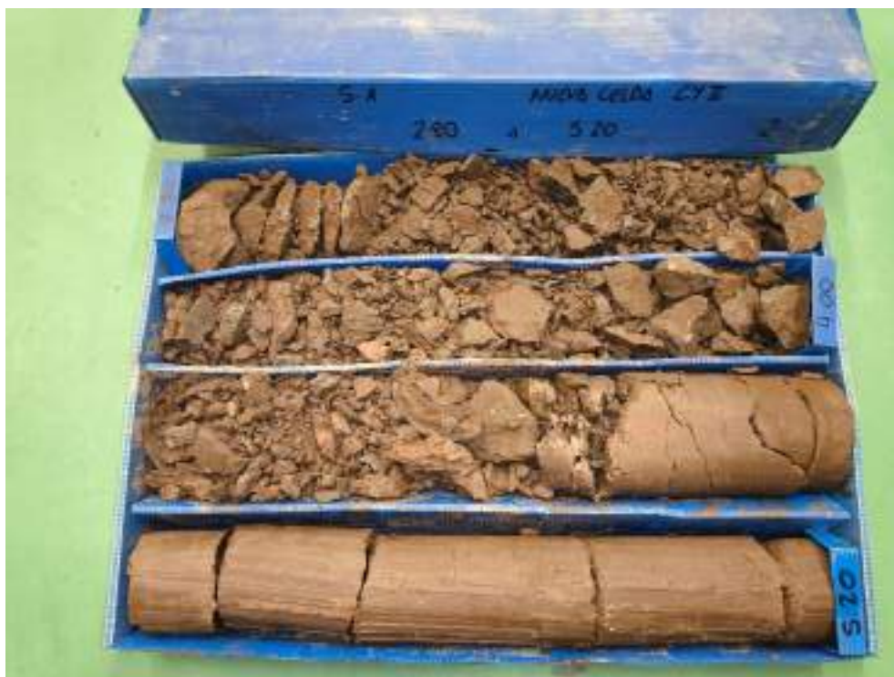
Sondeo S-1, caja 2, de 2,80 m a 5,20 m de profundidad.
