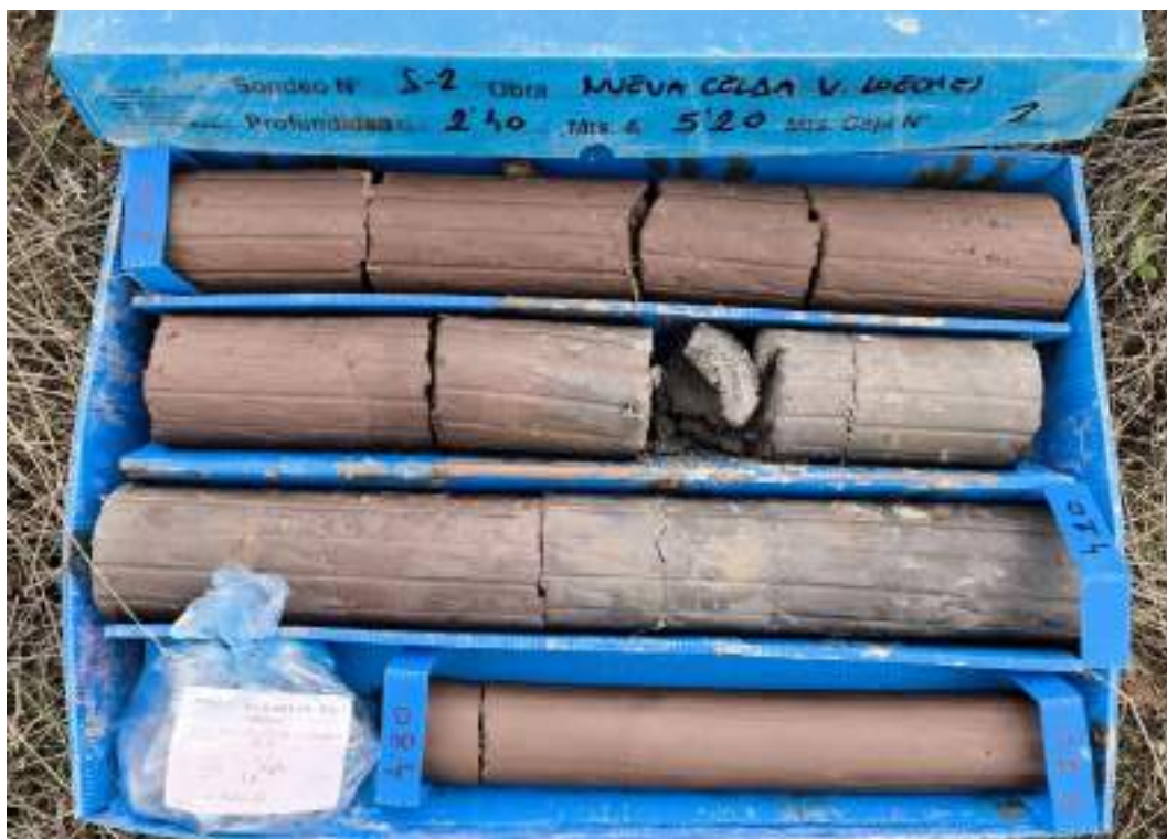
Sondeo S-2, caja 2, de 2,40 m a 5,20 m de profundidad.
