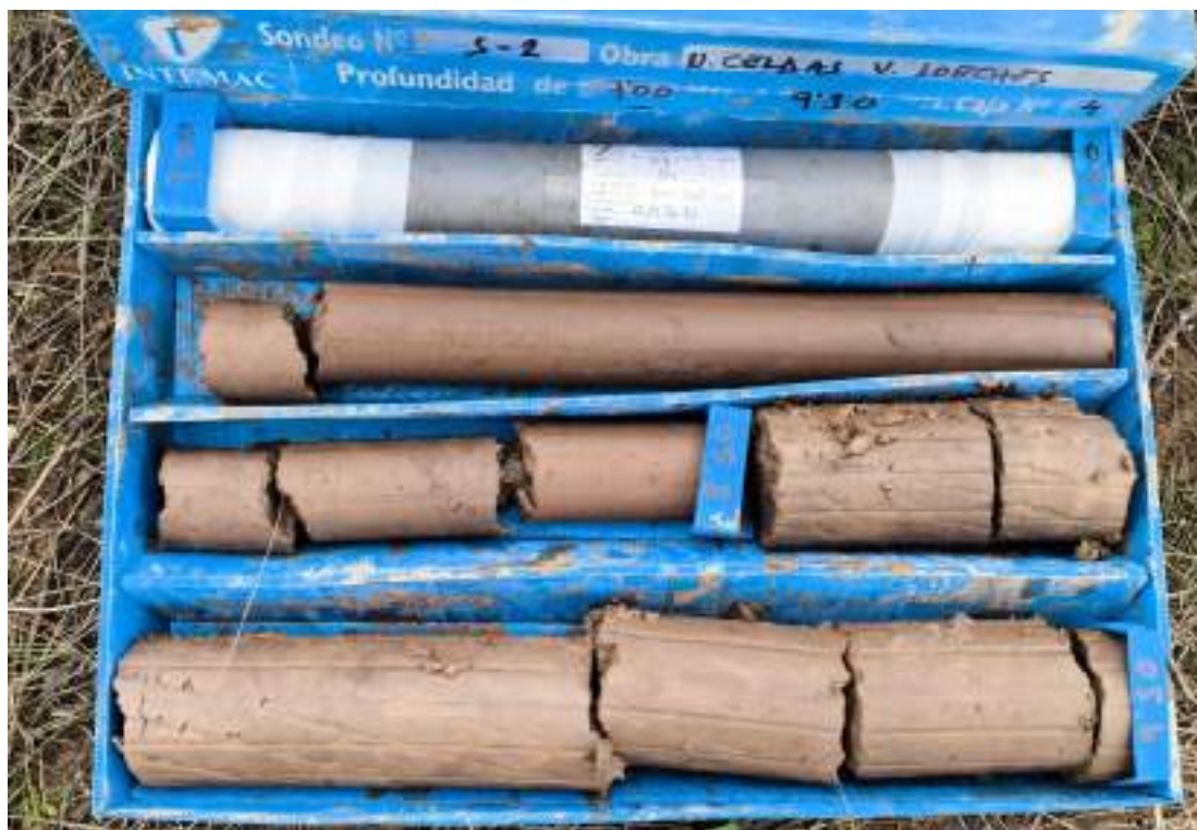
Sondeo S-2, caja 4, de 7,00 m a 9,30 m de profundidad.
