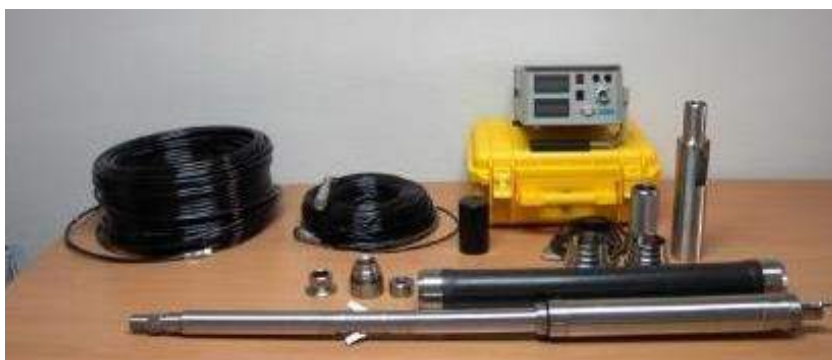
Figura 8. Equipo empleado para la realización de ensayos presiométricos
